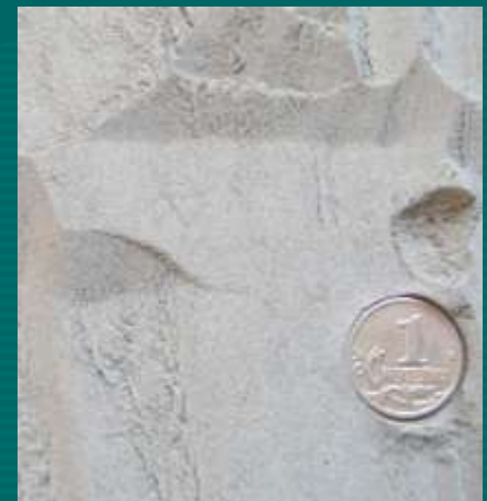
Гранитный отсев, разделенный на воздушном классификаторе.
