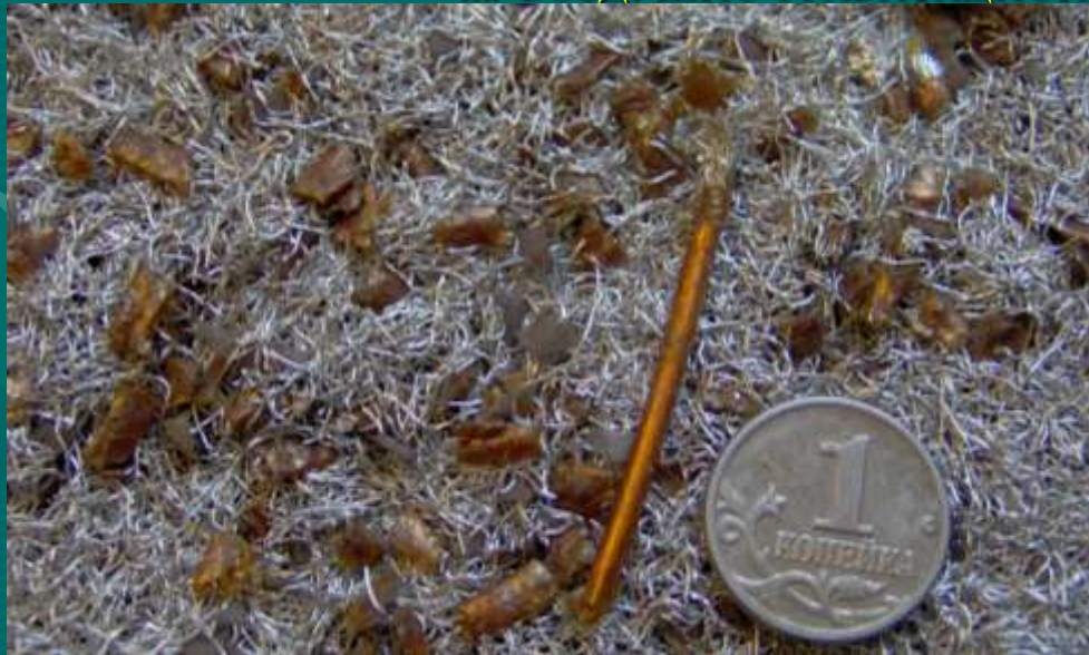
Металлический концентрат с нераскрытой изоляцией.
