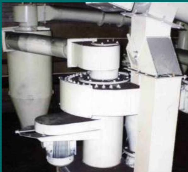
КЦД-1 в линии по производству тонкодисперсного шунгита.
