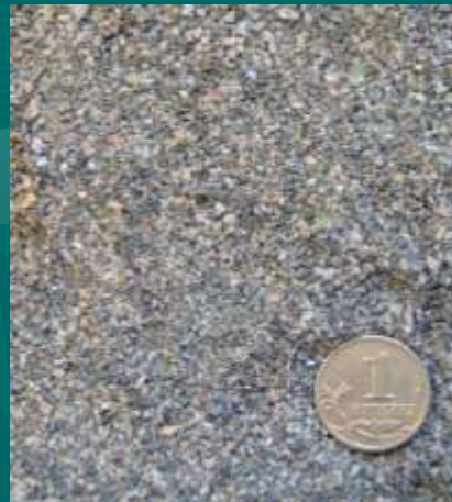
Гранитный отсев, разделенный на воздушном классификаторе.
