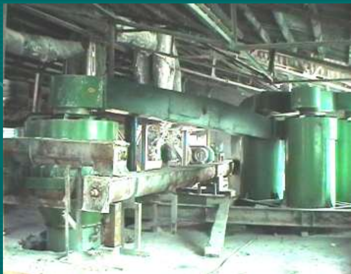
КЦС-10 в линии производства тонкодисперсного гипса
