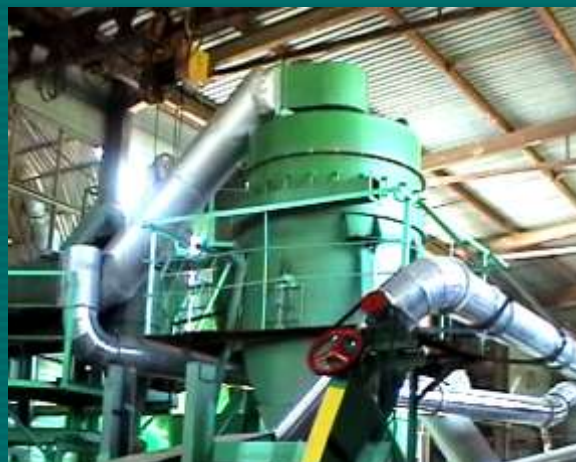
КЦС-10 в линии производства тонкодисперсного мела
