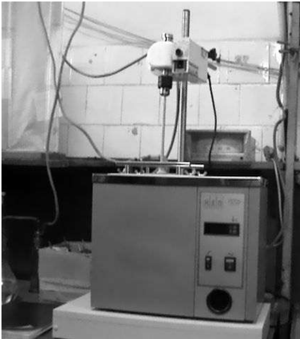
1 - стакан; 2 – двухлопастная мешалка с электроприводом; 3 - термостат; 4 - термометр; 5 - крышка; 6 - газоотводная трубка
