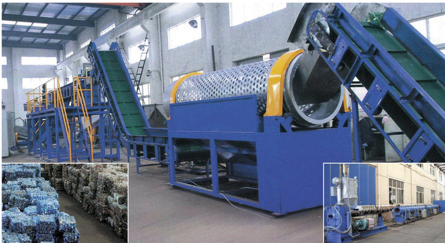
Отобранный на линии сортировки пластик (ПЭТ-бутылки, полимерная пленка, ПВД, ПНД) перерабатывается в пластиковый полуфабрикат (дробленый пластик, гранулят, синтетическое волокно).
