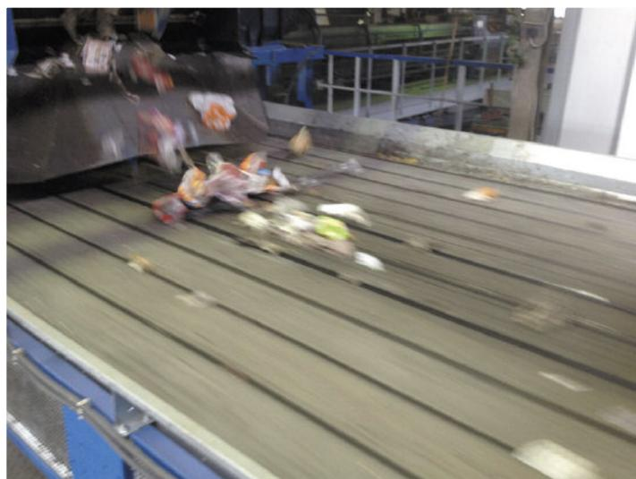
Автоматическая сортировка основана на использовании системы оптического сканирования, позволяющей извлечь различные материалы из смешанного или однородного потока отходов, учитывая физические и химические характеристики материала.
