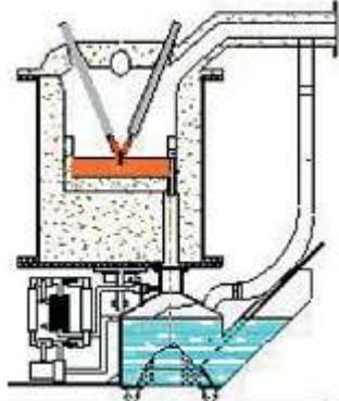
пост- камеры сгорания установки Platinum с Плазменным Факелом на 500 kW
