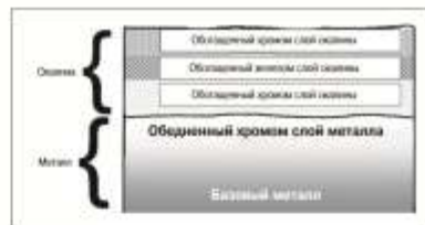
Рис. 1. Схема окислы на поверхности коррозионностойкой стали
