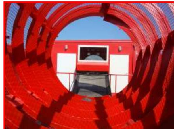
Сепаратор (сито) барабанного типа
